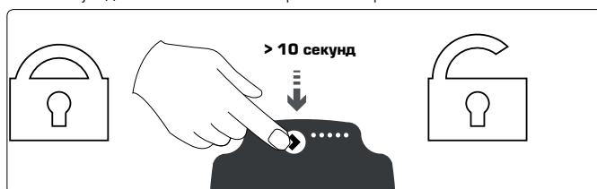
Если удерживать блокировку клавиш более 10 секунд то можно переключаться между включением/выключением этой функции. Если сделать это, все светодиоды загорятся на секунду, указывая на переключение блокировки.
