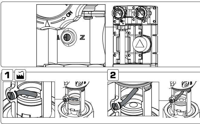
После полного заполнения системы и выпуска воздуха поверните винт на запорном клапане обратно в его нормальное рабочее положение (рис. 2) и настройте работу циркуляционного насоса в соответствии с системой. См. сведения о Wilo в главе 5 и о Grundfos в главе 6.
